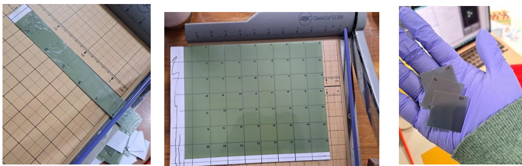
Figura 53 Plantilla de corte y corte de los trozos de película radiocrómica. Se destaca el emplayado y el uso de guantes para su correcta manipulación
