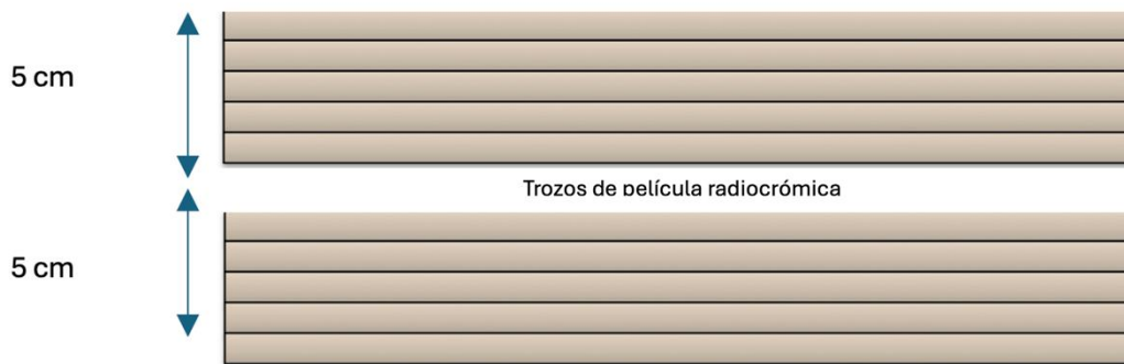
Figura 55 Arreglo experimental para la irradiación de películas radiocrómicas.
