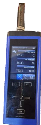
Figura 11 Termo-higrómetro-barómetro PCE XA1000
